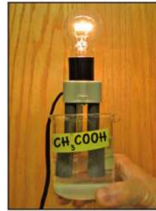
▲ شكل (١٣) الحمض القوي يوصل التيار الكهربى بدرجة أكبر من الحمض الضعيف
